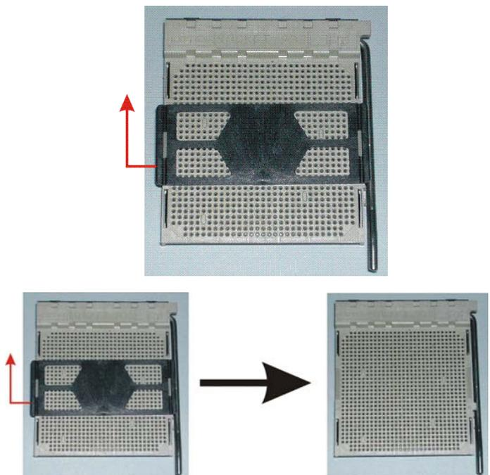
步骤 2: 将水平杆从插槽外水平接起至 90 度.
