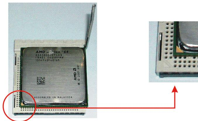
**步骤 4:** 固定 CPU, 将拉杆闭合。
