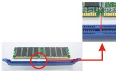
2. 垂直插入 DIMM 并固定好,直到固定夹跳回原位,DIMM 就位.
